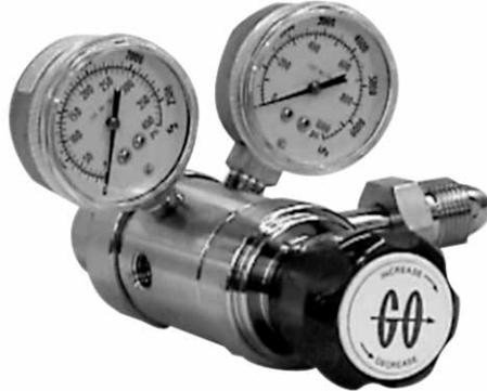
Les régulateurs CYL-20 permettent de contrôler la pression avec une grande précision. Ce régulateur à deux étages, en acier inoxydable 316L et PTFE, présente moins de 0,01 pour cent de variation de pression en sortie pour différentes pressions en entrée et est conçu pour être utilisé sur les systèmes d'étalonnage de gaz et dans le traitement des matériaux semi-conducteurs.
