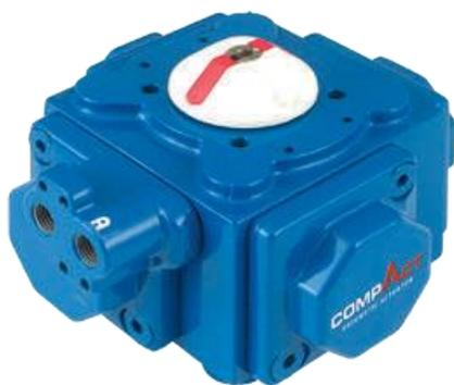
Les deux gammes de vannes ont été automatisées avec l'actionneur pneumatique à rappel par ressort à 4 pistons COMPACT™. Le COMPACT™ est l'actionneur à pignon et crémaillère le plus RAPIDE du marché. Sa conception unique à quatre pistons permet un pignon de diamètre inférieur, ce qui réduit considérablement la course du piston et réduit le temps de réponse.
