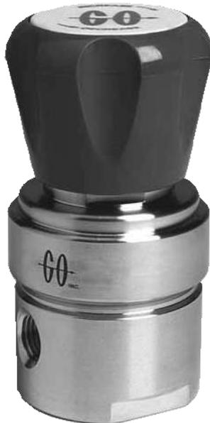
Le modèle PR-5 est un détendeur (Régulation de pression aval) conçu pour la régulation de précision sur une plage de débit importante. Conçu à l'origine pour les gaz, l'appareil peut aussi réguler la pression des liquides compatibles avec les matériaux de construction. Le PR-5 régule aussi très bien en faible débit (Quelques litres par minutes).
